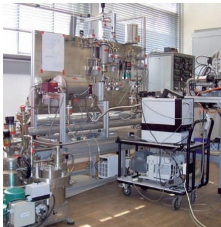
Mit dem Testexperiment TILO (Test Inner Loop) werden seit Mitte 2005 die Eigenschaften des geschlossenen Tritiumkreislaufs untersucht.
