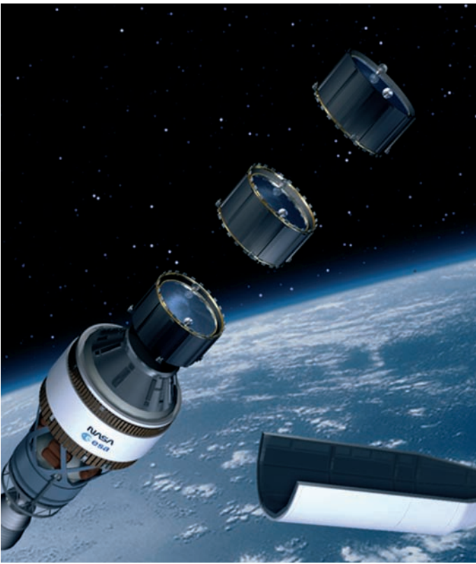
Abb. 26: Das Weltrauminterferometer LISA wird aus drei Satelliten bestehen, die ein Dreieck mit fünf Millionen Kilometer Kantenlänge aufspannen. Diese Computergrafik zeigt, wie die Satelliten aus der Trägerrakete austreten und ihren Formationsflug beginnen.
