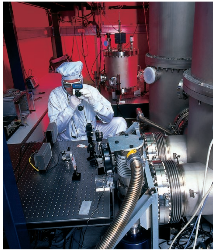
Abb. 27: Die optischen Komponenten des Gravitationswellen-Detektors GEO600 müssen exakt justiert werden. Nur so ist es möglich, die minimalen Raumverzerrungen zu messen, die eine Gravitationswelle hervorruft.
