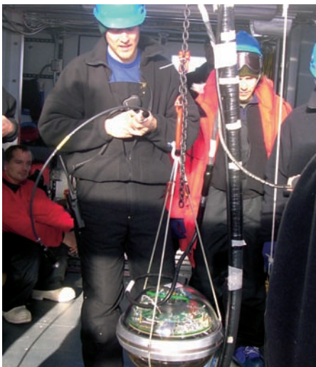
Installation eines Photomultipliers im antarktischen Eis.
