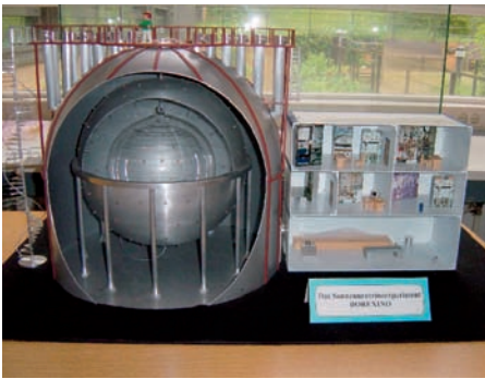
Modell des Borexino-Experiments. Der Detektor ist in einem Stahltank mit etwa 18 m Durchmesser untergebracht. Der zwiebelartige Aufbau zur Abschirmung gegen externen Untergrund ist deutlich zu erkennen. In dem Gebäude daneben befinden sich die Elektronik zur Datenaufnahme und zur Steuerung des Detektors sowie Reinräume, die beim Aufbau des Detektors genutzt wurden.
