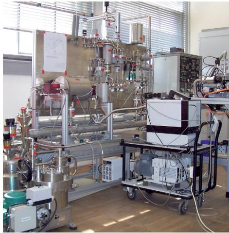
Mit dem Testexperiment TILO (Test Inner Loop) werden seit Mitte 2005 die Eigenschaften des geschlossenen Tritiumkreislaufs untersucht.
