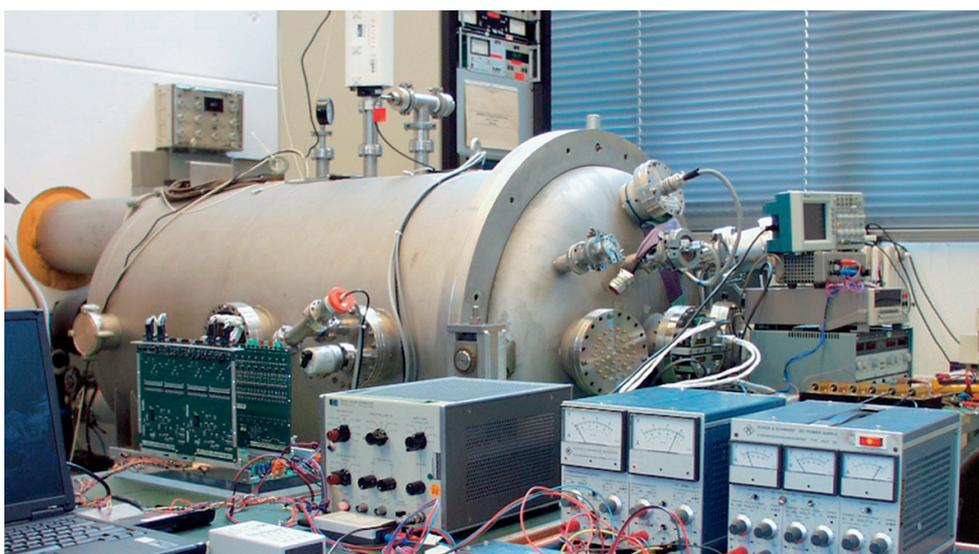
Test der AMS-Elektronik in einer Thermovakuumkammer des Max-Planck-Instituts für extraterrestrische Physik. Hier werden die großen Temperaturschwankungen und die fehlende Konvektionskühlung im Weltall nachgeahmt.
