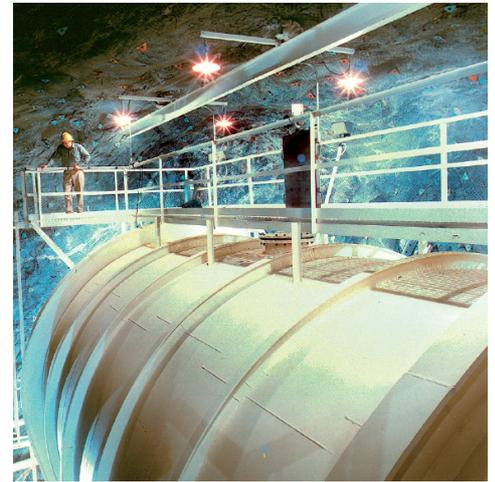
Abb. 15: Der amerikanische Physiker Ray Davis registrierte als Erster Neutrinos von der Sonne und stieß dabei auf das Sonnenneutrino-Rätsel. Sein Detektor bestand aus einem großen mit Tetrachloräthylen gefüllten Tank, in dem die Neutrinos bei Kernreaktionen wenige Argon-37-Isotope erzeugen, die mit einer hochsensitiven Methode nachgewiesen wurden. Davis erhielt hierfür 2002 den Nobelpreis für Physik.
