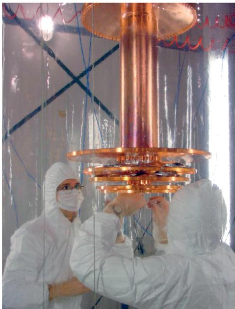
Die CRESST-Detektoren und der zu ihrer Kühlung notwendige Kryostat befinden sich in einem Kupfergefäß. Im Hintergrund ist ein Teil der Abschirmung gegen Umgebungsradioaktivität zu erkennen. Beim Einbau der Detektoren (rechts) darf keinerlei Staub in den Detektor gelangen, weil er natürliche radioaktive Stoffe enthält.
