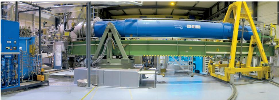
Oben: Der Aufbau des „Axionen-Sonnenteleskops“. Unten: Der supraleitende Magnet von CAST (blaue Röhre), in dem sich Axionen in Röntgenstrahlung umwandeln sollen. Rechts erkennbar das Helium-Kühlsystem, das den Magneten auf 2 Kelvin abkühlt.
