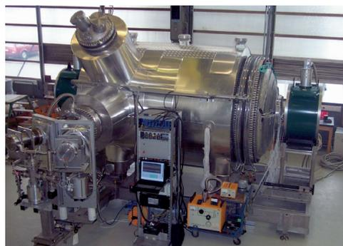
Das elektrostatische Vorspektrometer ist seit 2004 betriebsbereit und dient seither zum Test der Ultrahochvakuum-Techniken und der neuartigen elektromagnetischen Strahlführung.
