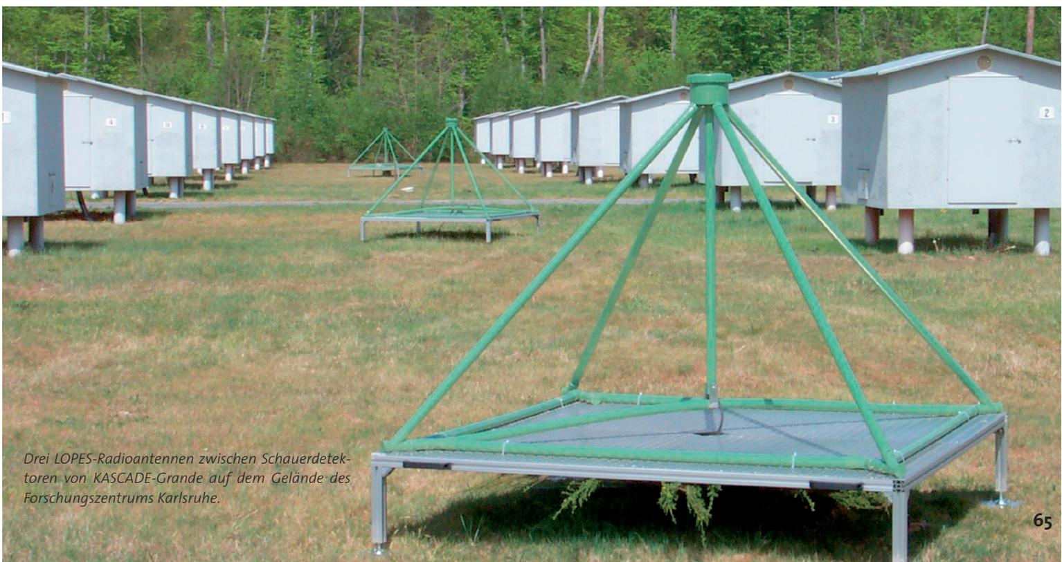
*Drei LOPES-Radioantennen zwischen Schauerdetektoren von KASCADE-Grande auf dem Gelände des Forschungszentrums Karlsruhe.*
