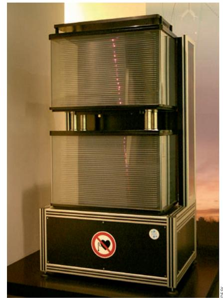
In einer Funkenkammer befinden sich mehrere unter Hochspannung stehende Platten, umgeben von einem Edelgas. Energiereiche Teilchen aus dem All schlagen Elektronen aus dessen Atomhülle, wodurch das Gas leitet und ein Funke zwischen den Platten überspringt. Eine rötlich leuchtende Ionisationsspur demonstriert so den Weg kosmischer Teilchenstrahlung.
