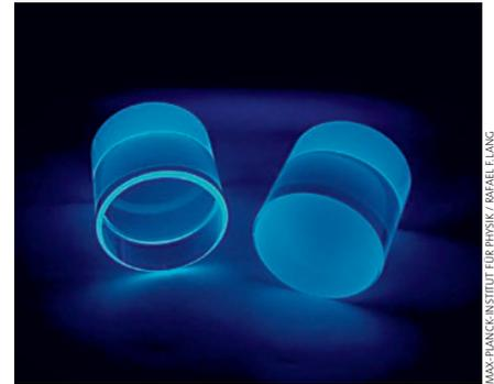
Im CRESST-Experiment werden Detektoren aus hochreinen Kristallen eingesetzt.
