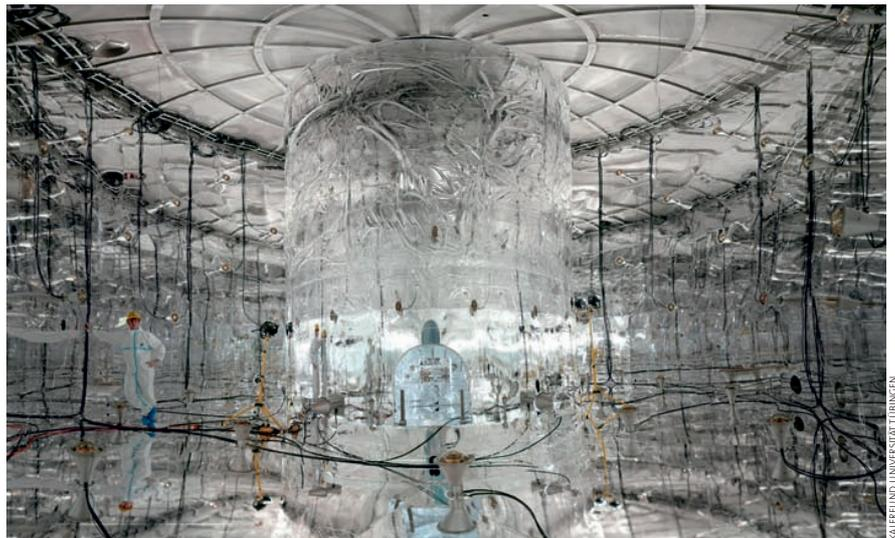
Der Detektor GERDA befindet sich in einem mit spezieller Folie ausgekleideten Wassertank, der Störsignale abschirmt.
